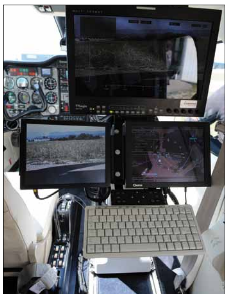
Pracoviště operátora ve verzi pro pátrání, záchranu a TV přenosy, kontejner s výtahem kamerové hlavy.
